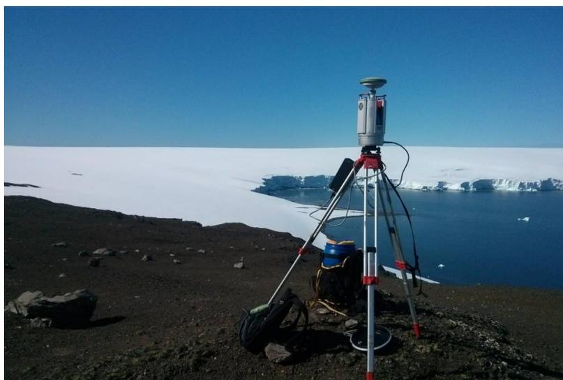
Figura 2 - Conjunto Laser scanner terrestre e receptor GNSS. Ao fundo geleira limite da área de estudo.
