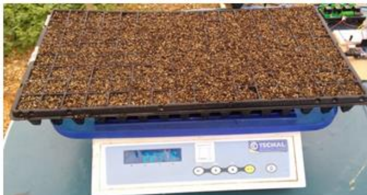
Figura 2. Bandeja sobre balança representando esquema da lisimetria de pesagem.
