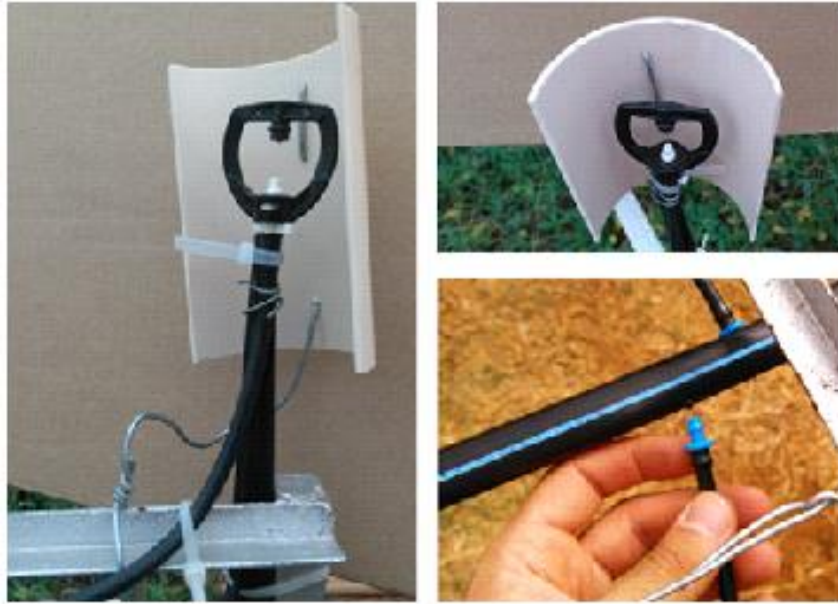
Figura 3: Esquerda: microaspersor de jato fixo 360, posicionado verticalmente para cima, atado à mesa metálica por abraçadeiras plásticas. Direita - superior: microaspersor posicionado no lado côncavo do aparador. Direita – inferior: encaixe do microtúbulos na mangueira de polietileno.
