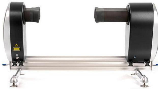
**Figura 1.** Analisador de partículas utilizado no experimento. (Fonte: [www.malvern.com](http://www.malvern.com))
