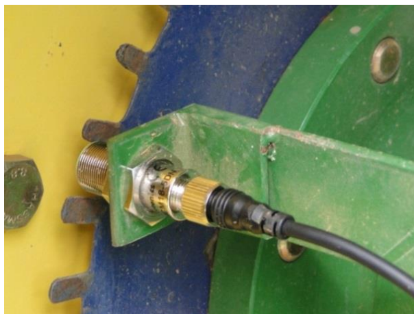
Figura 4. Sensor indutivo utilizado para a determinação da velocidade angular dos rodados.
