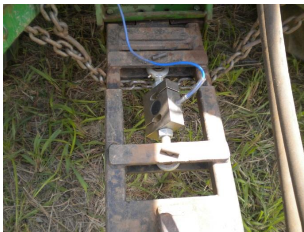
Figura 5. Célula de carga e estrutura suporte para a instalação no trator.
